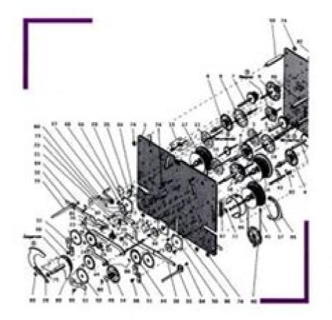
Ersatzteilekatalog - Uhrwerke Spare parts for movements Fournitures pour mouvements
