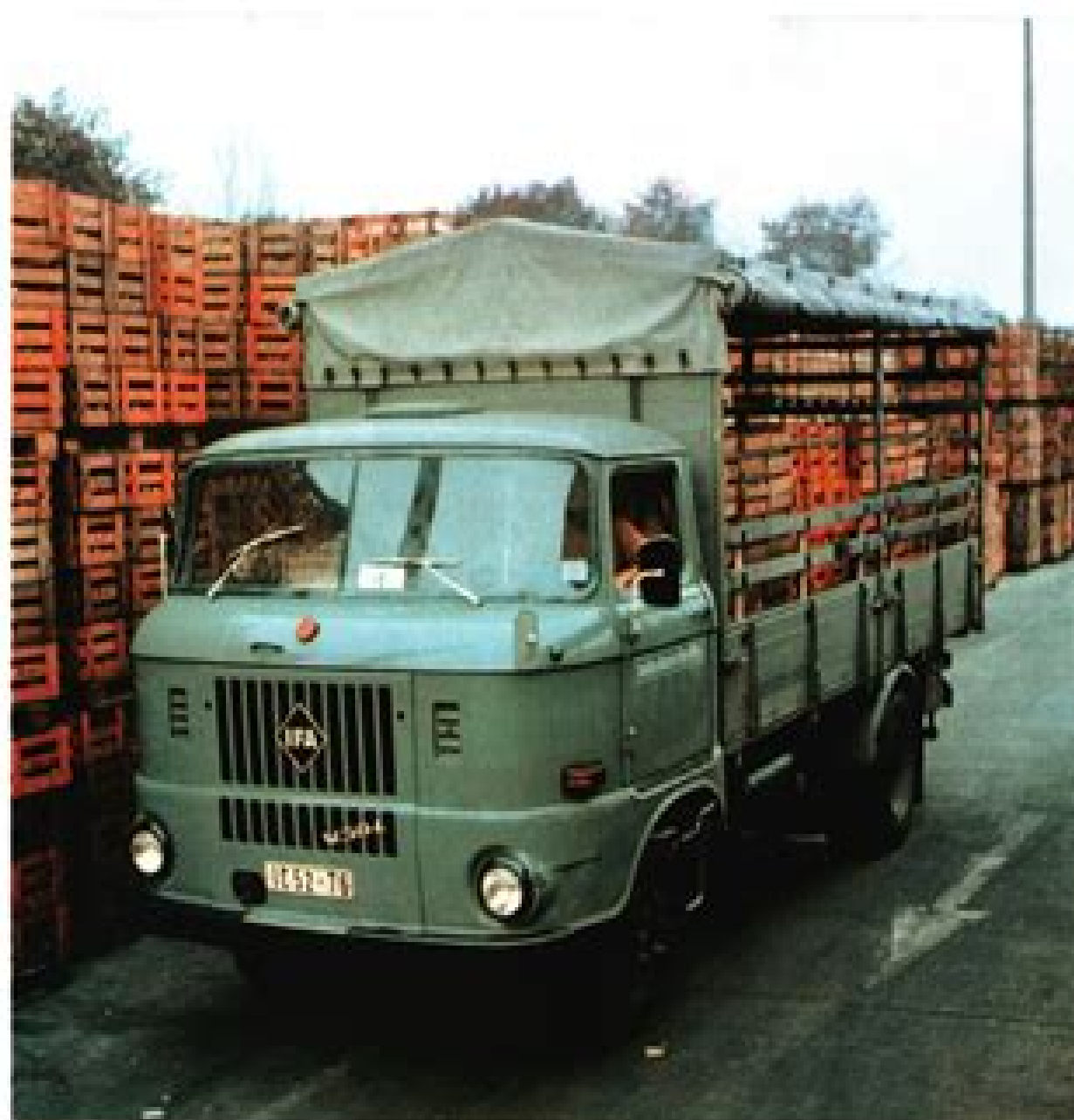
Abb. 2, 4 und 5: Ebenso vielseitig verwendbar ist das Speditionspritschenfahrzeug W 50 L/Sp; hier eingesetzt als Auslieferungsfahrzeug der Getränkeindustrie und beim Handelstransport im Haus-zu-Haus-Verkehr.
